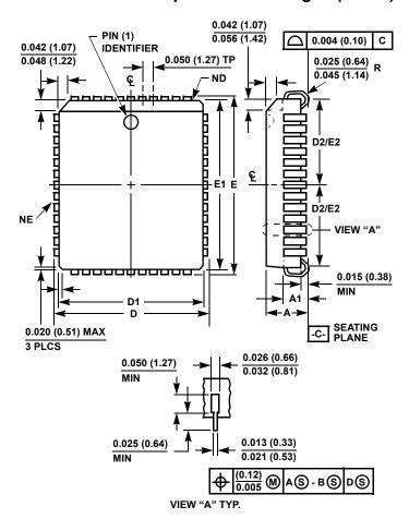
N32.45x55 (JEDEC MS-016AE ISSUE A) 32 LEAD PLASTIC LEADED CHIP CARRIER PACKAGE
